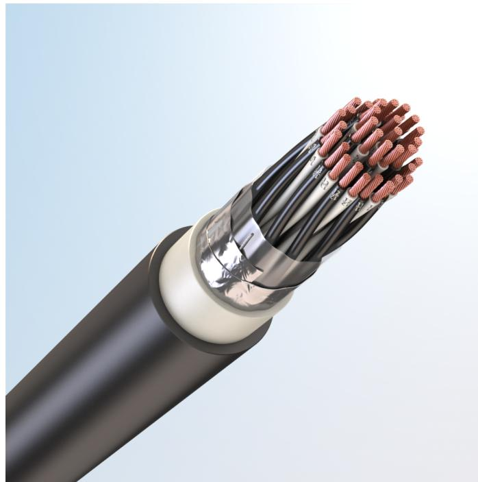
Кабель монтажный универсальный, с медными токопроводящими жилами, с изоляцией из полимерной композиции, не содержащей галогенов, с общим экраном из медных луженых проволок, с наружной оболочкой из полимерной композиции пониженной пожарной опасности, не содержащей галогенов
