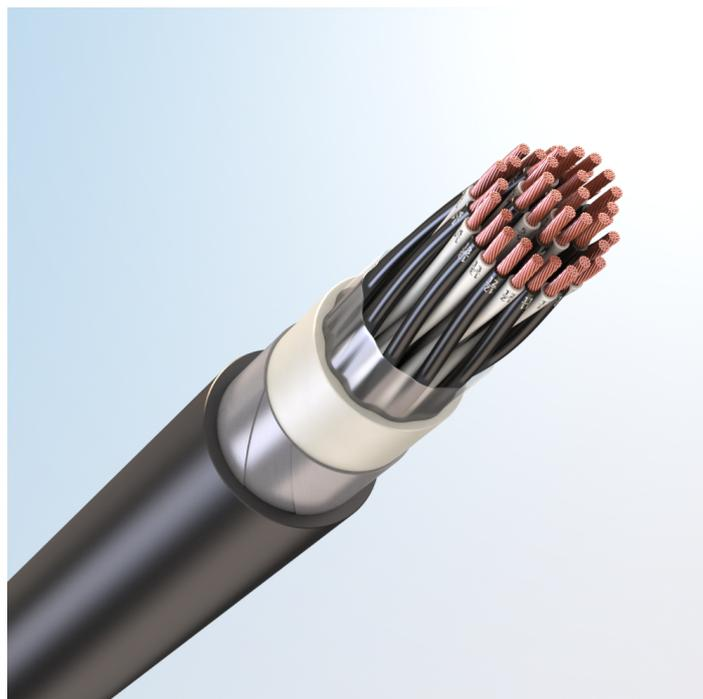
Кабель монтажный универсальный, с медными токопроводящими жилами, с изоляцией из термопластичного эластомера, бронированный стальными оцинкованными лентами, с наружной оболочкой из термопластичного эластомера пониженной пожарной опасности
