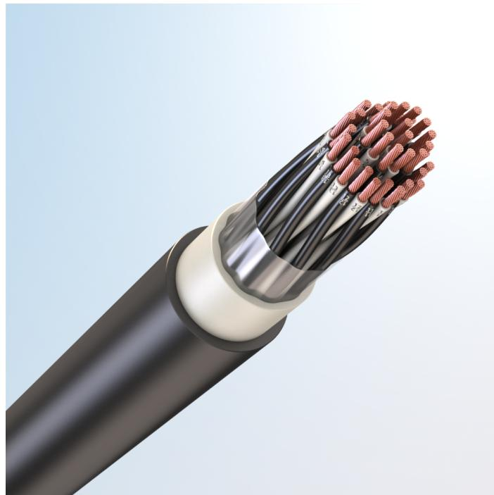
Кабель монтажный универсальный, с медными токопроводящими жилами, с изоляцией из термопластичного эластомера, с наружной оболочкой из термопластичного эластомера пониженной пожарной опасности
