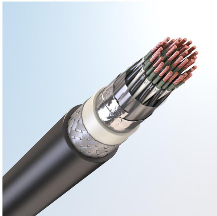
Кабель монтажный универсальный, огнестойкий, с медными токопроводящими жилами, с обмоткой по токопроводящим жилам слюдосодержащей лентой, с изоляцией из термопластичного эластомера, с общим экраном из алюмополимерных лент, бронированный стальными оцинкованными проволоками, с наружной оболочкой из термопластичного эластомера пониженной пожарной опасности
