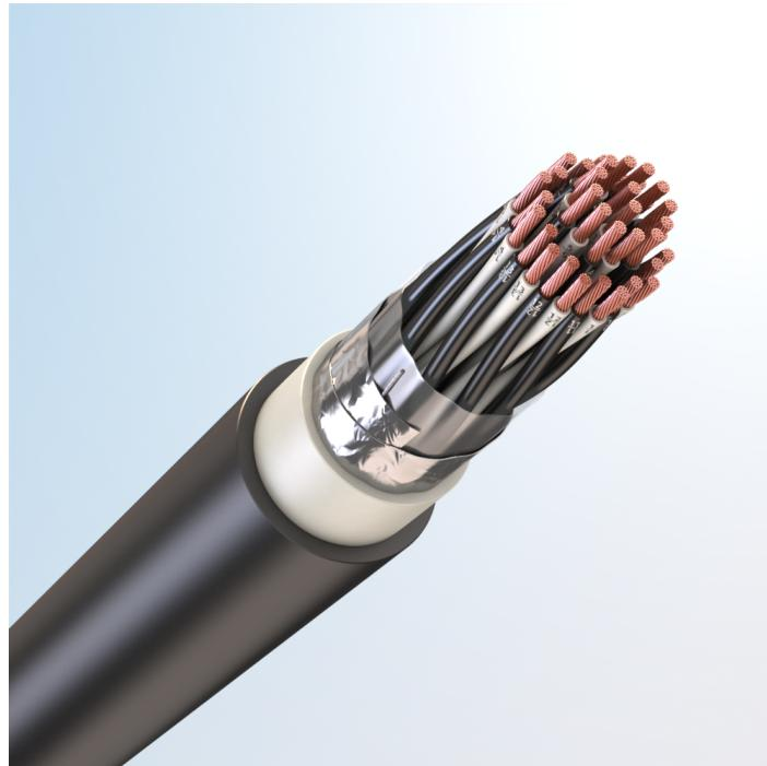
Кабель монтажный универсальный, с медными токопроводящими жилами, с изоляцией из термопластичного эластомера, с общим экраном из медных луженых проволок, с наружной оболочкой из термопластичного эластомера пониженной пожарной опасности
