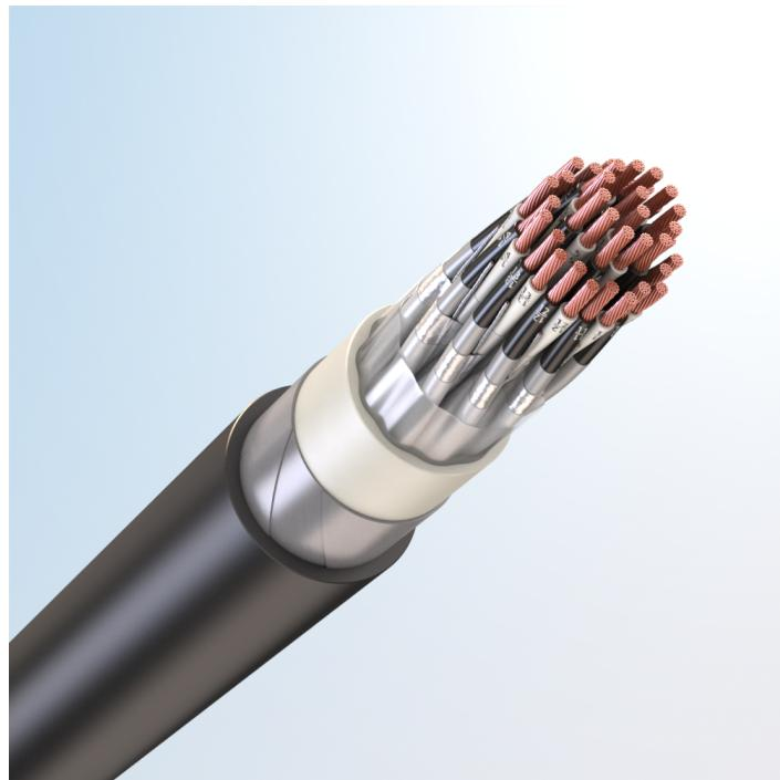
Кабель монтажный универсальный, с медными токопроводящими жилами, с изоляцией из поливинилхлоридного пластика, с экраном по группам из алюмополимерной ленты, бронированный стальными оцинкованными лентами, с наружной оболочкой из хладостойкого поливинилхлоридного пластика пониженной пожарной опасности, с низким дымо- и газовыделением
