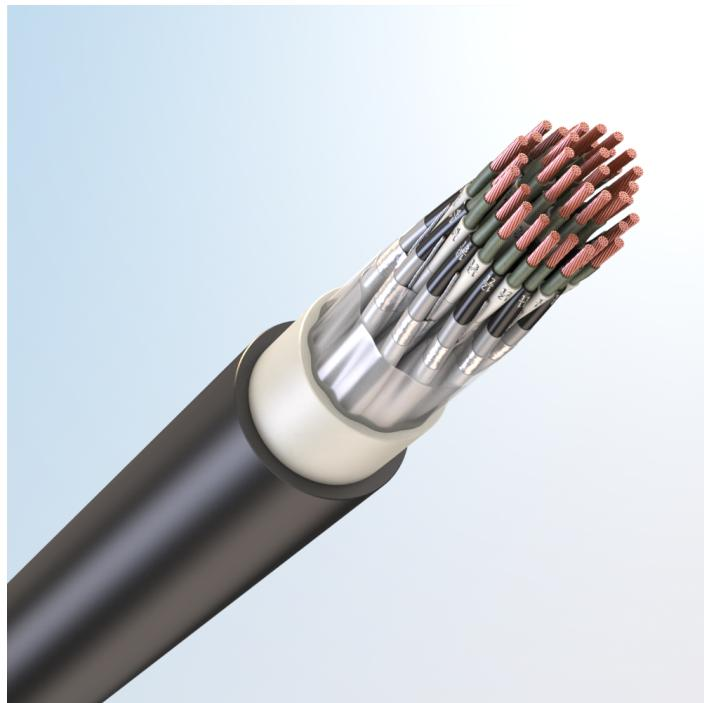
Кабель монтажный универсальный, огнестойкий, с медными токопроводящими жилами, с обмоткой по токопроводящим жилам слюдосодержащей лентой, с изоляцией из поливинилхлоридного пластика, с экраном по группам из алюмополимерной ленты, с наружной оболочкой из поливинилхлоридного пластика пониженной пожарной опасности, с низким дымо- и газовыделением
