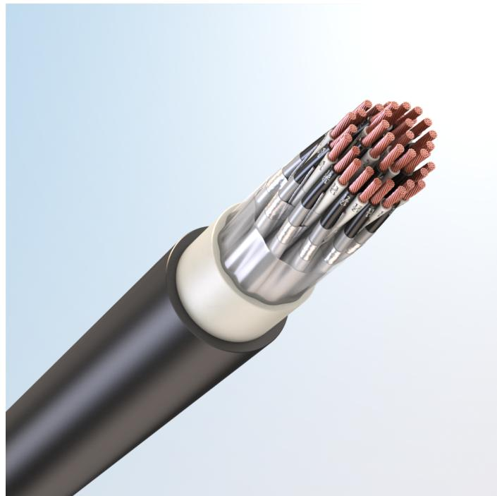
Кабель монтажный универсальный, с медными токопроводящими жилами, с изоляцией из поливинилхлоридного пластика, с экраном по группам из алюмополимерной ленты, с наружной оболочкой из поливинилхлоридного пластика пониженной пожарной опасности, с низким дымо- и газовыделением
