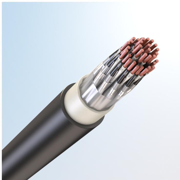
Кабель монтажный универсальный, с медными токопроводящими жилами, с изоляцией из поливинилхлоридного пластиката, с экраном по группам из алюмополимерной ленты, с наружной оболочкой из хладостойкого поливинилхлоридного пластиката пониженной пожарной опасности, с низким дымо- и газовыделением
