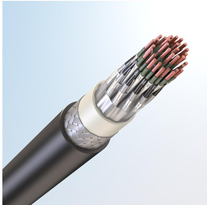
Кабель монтажный универсальный, огнестойкий, с медными токопроводящими жилами, с обмоткой по токопроводящим жилам слюдосодержащей лентой, с изоляцией из поливинилхлоридного пластика, с экраном по группам из алюмополимерной ленты, бронированный стальными оцинкованными проволоками, с наружной оболочкой из хладостойкого поливинилхлоридного пластика пониженной пожарной опасности, с низким дымо- и газовыделением
