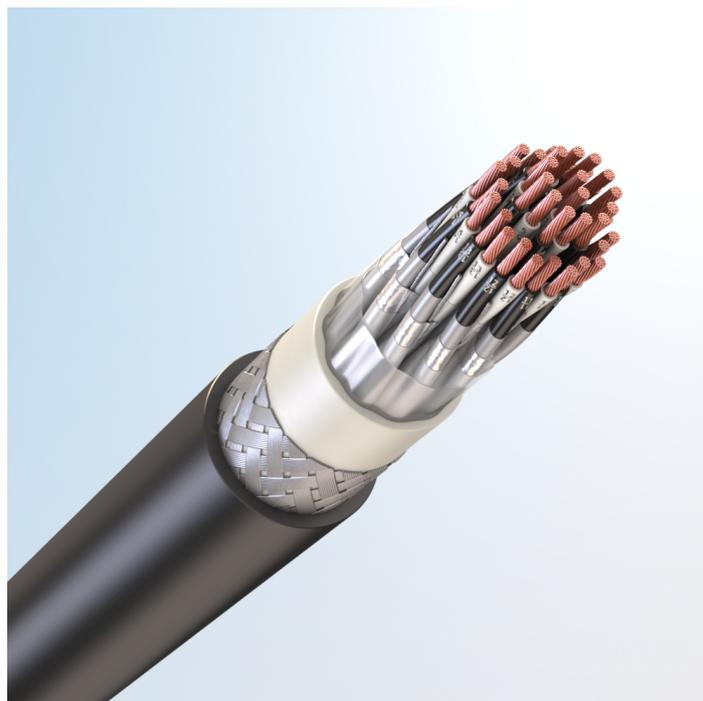
Кабель монтажный универсальный, с медными токопроводящими жилами, с изоляцией из поливинилхлоридного пластиката, с экраном по группам из алюмополимерной ленты, бронированный стальными оцинкованными проволоками, с наружной оболочкой из хладостойкого поливинилхлоридного пластиката пониженной пожарной опасности, с низким дымо- и газовыделением
