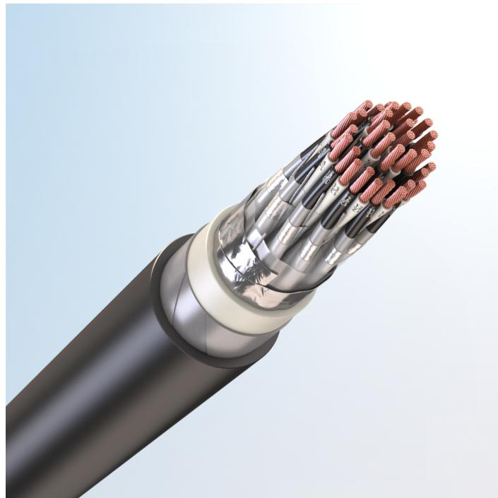
Кабель монтажный универсальный, с медными токопроводящими жилами, с изоляцией из поливинилхлоридного пластика, с экраном по группам из алюмополимерных лент, с общим экраном из алюмополимерных лент, бронированный стальными оцинкованными лентами, с наружной оболочкой из поливинилхлоридного пластика пониженной пожарной опасности, с низким дымо- и газовыделением
