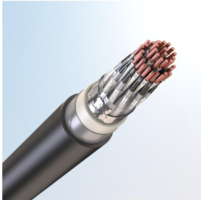
Кабель монтажный универсальный, с медными токопроводящими жилами, с изоляцией из поливинилхлоридного пластика, с экраном по группам из алюмополимерных лент, с общим экраном из алюмополимерных лент, бронированный стальными оцинкованными лентами, с наружной оболочкой из хладостойкого поливинилхлоридного пластика пониженной пожарной опасности
