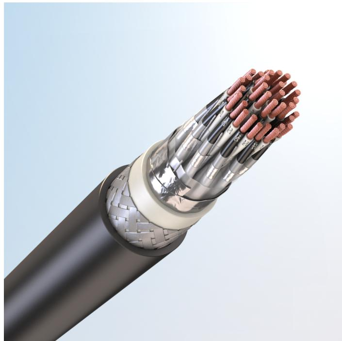
Кабель монтажный универсальный, с медными токопроводящими жилами, с изоляцией из поливинилхлоридного пластика, с экраном по группам из алюмополимерных лент, с общим экраном из алюмополимерных лент, бронированный стальными оцинкованными проволоками, с наружной оболочкой из поливинилхлоридного пластика пониженной пожарной опасности
