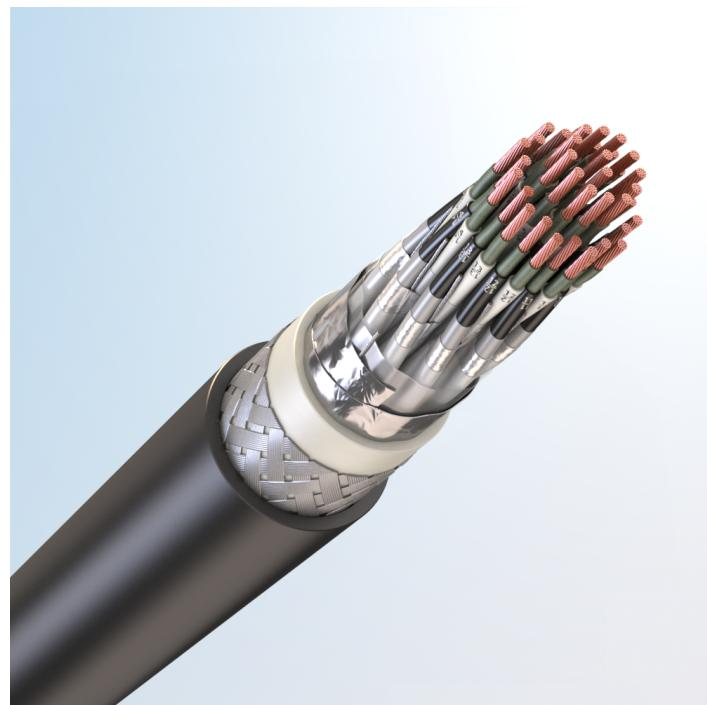
Кабель монтажный универсальный, огнестойкий, с медными токопроводящими жилами, с обмоткой по токопроводящим жилам слюдосодержащей лентой, с изоляцией из поливинилхлоридного пластика, с экраном по группам из алюмополимерных лент, с общим экраном из алюмополимерных лент, бронированный стальными оцинкованными проволоками, с наружной оболочкой из поливинилхлоридного пластика пониженной пожарной опасности, с низким дымо- и газовыделением
