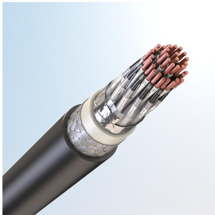
Кабель монтажный универсальный, с медными токопроводящими жилами, с изоляцией из поливинилхлоридного пластика, с экраном по группам из алюмополимерных лент, с общим экраном из алюмополимерных лент, бронированный стальными оцинкованными проволоками, с наружной оболочкой из поливинилхлоридного пластика пониженной пожарной опасности, с низким дымо- и газовыделением
