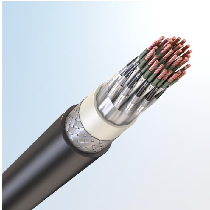
Кабель монтажный универсальный, огнестойкий, с медными токопроводящими жилами, с обмоткой по токопроводящим жилам слюдосодержащей лентой, с изоляцией из полимерной композиции, не содержащей галогенов, с экраном по группам из алюмополимерной ленты, бронированный стальными оцинкованными проволоками, с наружной оболочкой из полимерной композиции пониженной пожарной опасности, не содержащей галогенов
