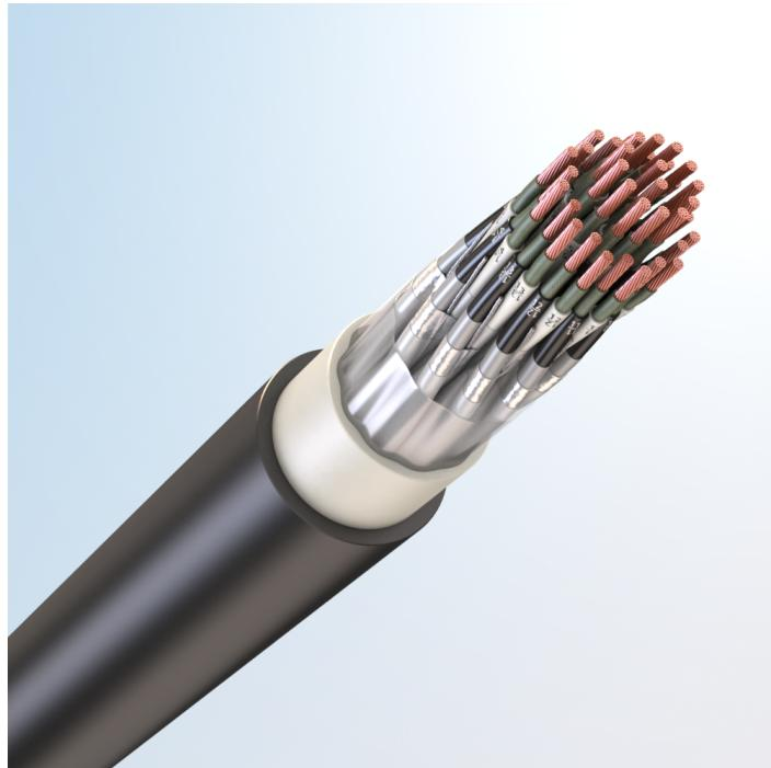
Кабель монтажный универсальный, огнестойкий, с медными токопроводящими жилами, с обмоткой по токопроводящим жилам слюдосодержащей лентой, с изоляцией из полимерной композиции, не содержащей галогенов, с экраном по группам из алюмополимерной ленты, с наружной оболочкой из полимерной композиции пониженной пожарной опасности, не содержащей галогенов
