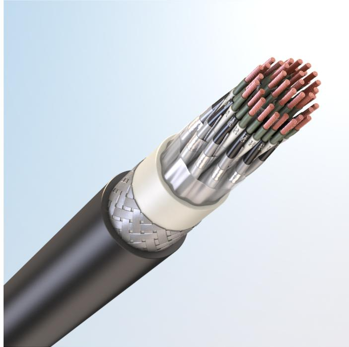
Кабель монтажный универсальный, огнестойкий, с медными токопроводящими жилами, с обмоткой по токопроводящим жилам слюдосодержащей лентой, с изоляцией из сшитого полиолефина, с экраном по группам из алюмополимерной ленты, бронированный стальными оцинкованными проволоками, с наружной оболочкой из поливинилхлоридного пластика пониженной пожарной опасности, с низким дымо- и газовыделением
