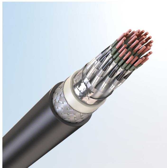
Кабель монтажный универсальный, огнестойкий, с медными токопроводящими жилами, с обмоткой по токопроводящим жилам слюдосодержащей лентой, с изоляцией из сшитого полиолефина, с экраном по группам из алюмополимерных лент, с общим экраном из алюмополимерных лент, бронированный стальными оцинкованными проволоками, с наружной оболочкой из поливинилхлоридного пластика пониженной пожарной опасности, с низким дымо- и газовыделением
