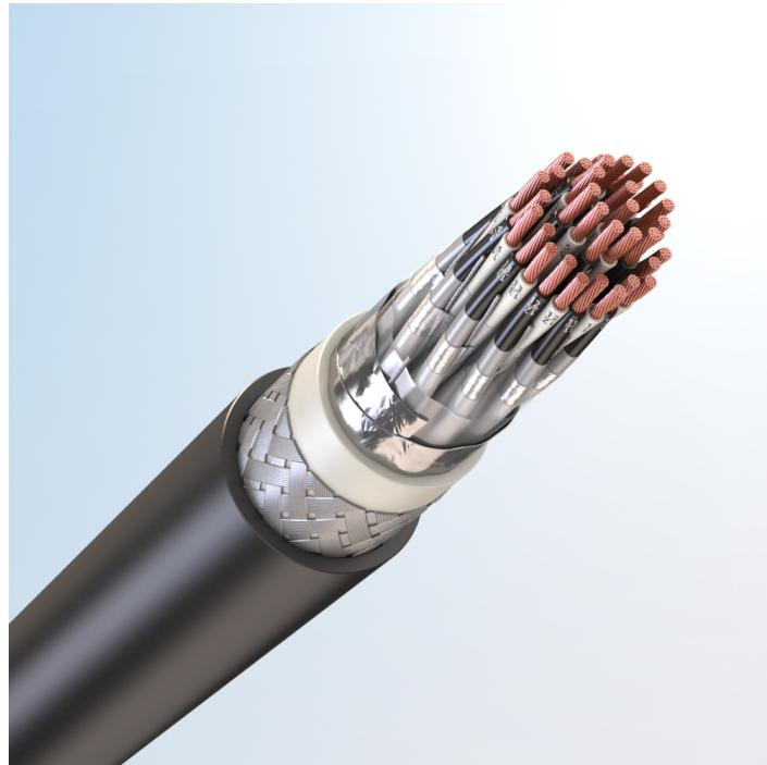
Кабель монтажный универсальный, с медными токопроводящими жилами, с изоляцией из спитого полиолефина, с экраном по группам из алюмополимерных лент, с общим экраном из алюмополимерных лент, бронированный стальными оцинкованными проволоками, с наружной оболочкой из хладостойкого поливинилхлоридного пластика пониженной пожарной опасности, с низким дымо- и газовыделением
