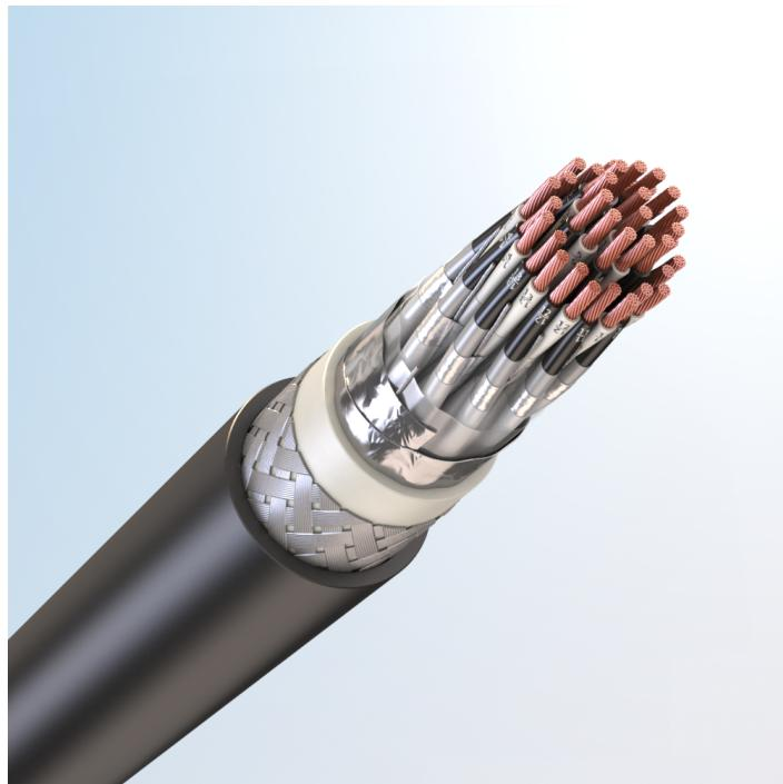
Кабель монтажный универсальный, с медными токопроводящими жилами, с изоляцией из спитого полиолефина, с экраном по группам из алюмополимерных лент, с общим экраном из алюмополимерных лент, бронированный стальными оцинкованными проволоками, с наружной оболочкой из полимерной композиции пониженной пожарной опасности, не содержащей галогенов
