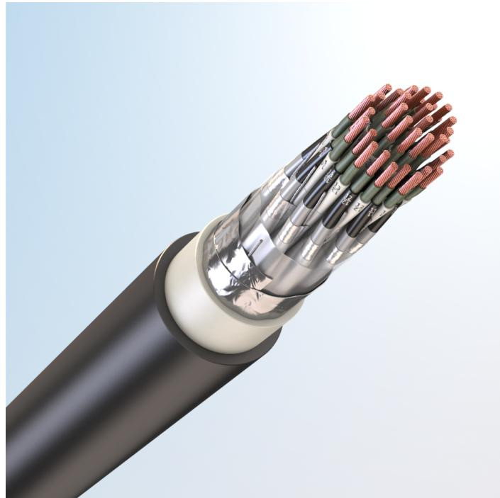
Кабель монтажный универсальный, огнестойкий, с медными токопроводящими жилами, с обмоткой по токопроводящим жилам слюдосодержащей лентой, с изоляцией из сшитого полиолефина, с экраном по группам из алюмополимерных лент, с общим экраном из алюмополимерных лент, с наружной оболочкой из полимерной композиции пониженной пожарной опасности, не содержащей галогенов
