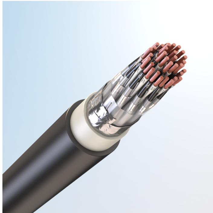
Кабель монтажный универсальный, с медными токопроводящими жилами, с изоляцией из спитого полиолефина, с экраном по группам из алюмополимерных лент, с общим экраном из алюмополимерных лент, с наружной оболочкой из полимерной композиции пониженной пожарной опасности, не содержащей галогенов
