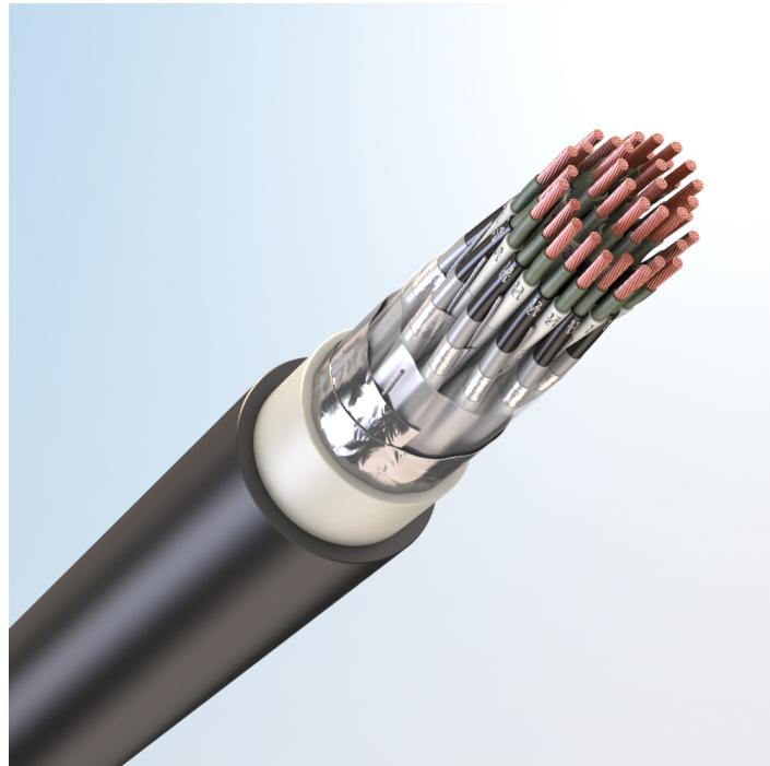
Кабель монтажный универсальный, огнестойкий, с медными токопроводящими жилами, с обмоткой по токопроводящим жилам слюдосодержащей лентой, с изоляцией из сшитого полиолефина, с экраном по группам из алюмополимерной ленты, с общим экраном из медных проволок, с наружной оболочкой из полимерной композиции пониженной пожарной опасности, не содержащей галогенов
