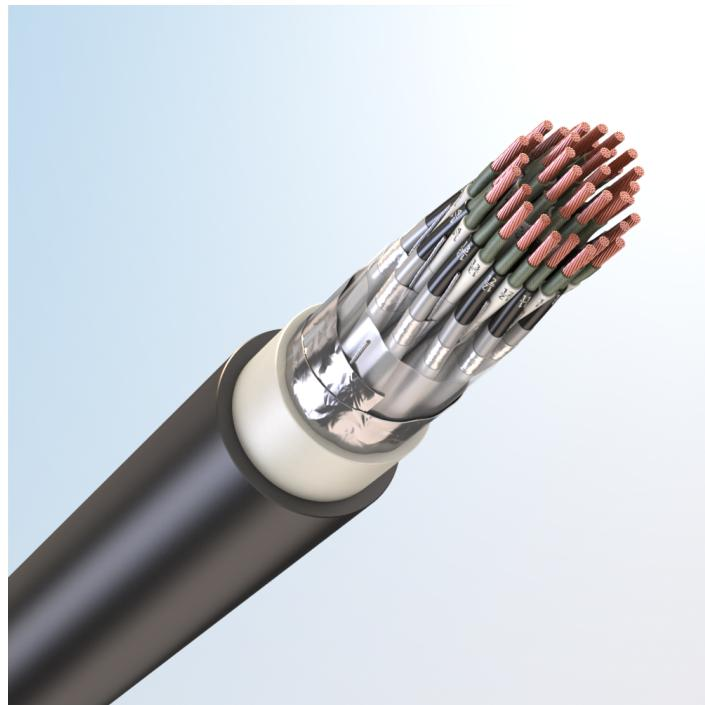
Кабель монтажный универсальный, огнестойкий, с медными токопроводящими жилами, с обмоткой по токопроводящим жилам слюдосодержащей лентой, с изоляцией из полимерной композиции, не содержащей галогенов, с экраном по группам из алюмополимерных лент, с общим экраном из алюмополимерных лент, с наружной оболочкой из полимерной композиции пониженной пожарной опасности, не содержащей галогенов
