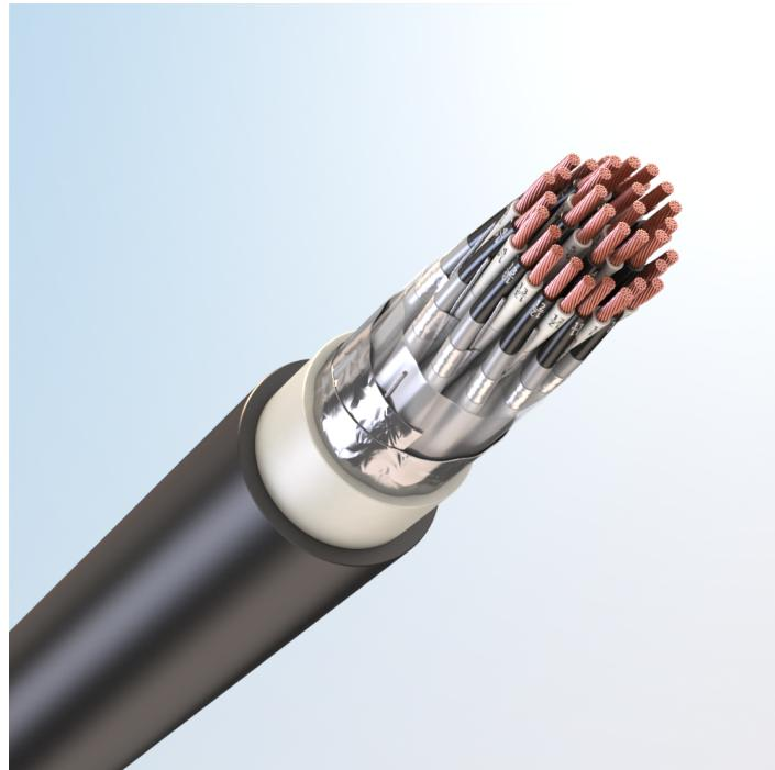
Кабель монтажный универсальный, с медными токопроводящими жилами, с изоляцией из полимерной композиции, не содержащей галогенов, с экраном по группам из алюмополимерных лент, с общим экраном из алюмополимерных лент, с наружной оболочкой из полимерной композиции пониженной пожарной опасности, не содержащей галогенов
