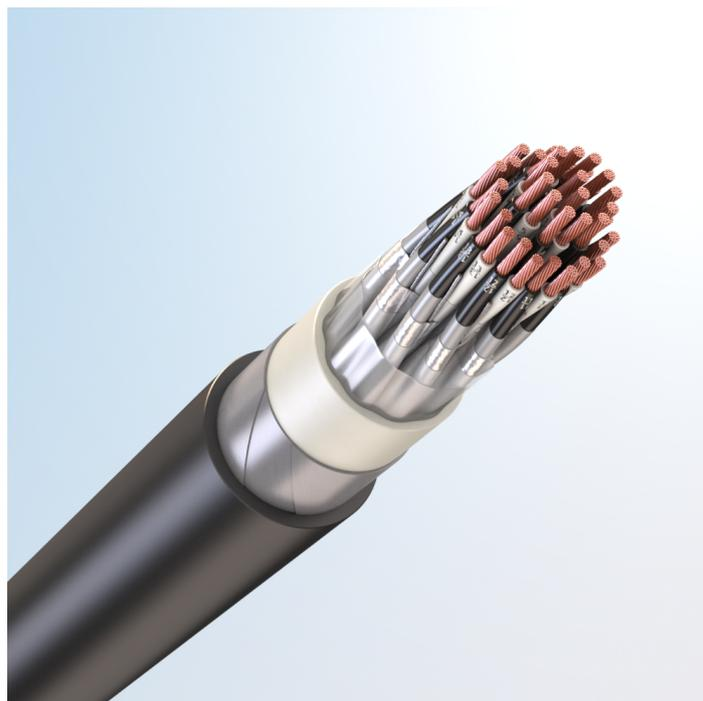
Кабель монтажный универсальный, с медными токопроводящими жилами, с изоляцией из поливинилхлоридного пластиката, с экраном по группам из медных проволок, бронированный стальными оцинкованными лентами, с наружной оболочкой из хладостойкого поливинилхлоридного пластиката пониженной пожарной опасности
