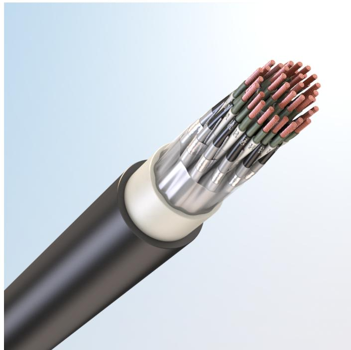
Кабель монтажный универсальный, огнестойкий, с медными токопроводящими жилами, с обмоткой по токопроводящим жилам слюдосодержащей лентой, с изоляцией из поливинилхлоридного пластика, с экраном по группам из медных проволок, с наружной оболочкой из поливинилхлоридного пластика пониженной пожарной опасности, с низким дымо- и газовыделением
