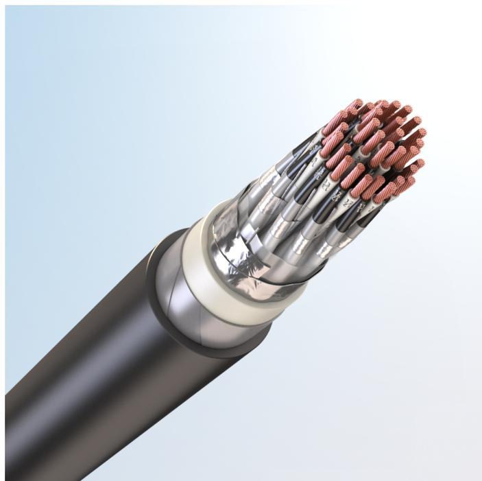
Кабель монтажный универсальный, с медными токопроводящими жилами, с изоляцией из поливинилхлоридного пластиката, с экраном по группам из медных проволок, с общим экраном из алюмополимерных лент, бронированный стальными оцинкованными лентами, с наружной оболочкой из поливинилхлоридного пластиката пониженной пожарной опасности, с низким дымо- и газовыделением
