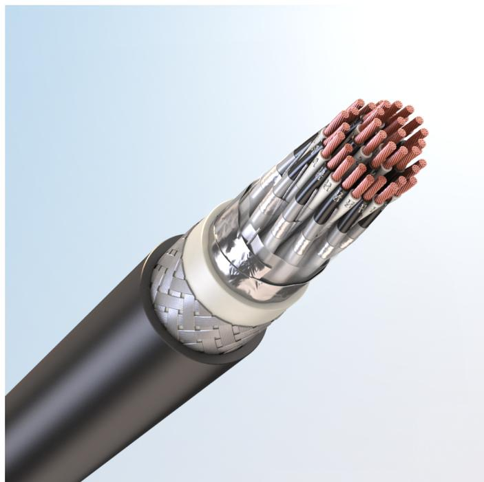
Кабель монтажный универсальный, с медными токопроводящими жилами, с изоляцией из поливинилхлоридного пластика, с экраном по группам из медных проволок, с общим экраном из алюмополимерных лент, бронированный стальными оцинкованными проволоками, с наружной оболочкой из поливинилхлоридного пластика пониженной пожарной опасности, с низким дымо- и газовыделением
