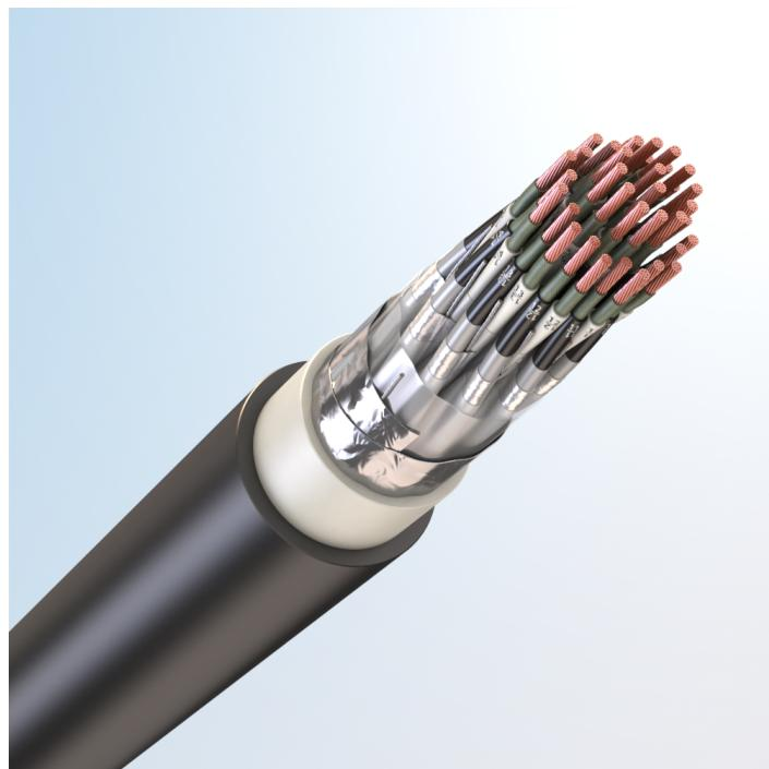
Кабель монтажный универсальный, огнестойкий, с медными токопроводящими жилами, с обмоткой по токопроводящим жилам слюдосодержащей лентой, с изоляцией из поливинилхлоридного пластика, с экраном по группам из медных проволок, с общим экраном из медных проволок, с наружной оболочкой из поливинилхлоридного пластика пониженной пожарной опасности, с низким дымо- и газовыделением
