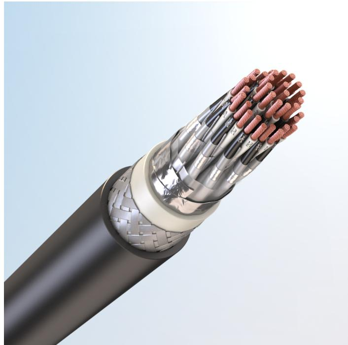
Кабель монтажный универсальный, с медными токопроводящими жилами, с изоляцией из поливинилхлоридного пластика, с экраном по группам из медных проволок, с общим экраном из медных проволок, бронированный стальными оцинкованными проволоками, с наружной оболочкой из поливинилхлоридного пластика пониженной пожарной опасности, с низким дымо- и газовыделением
