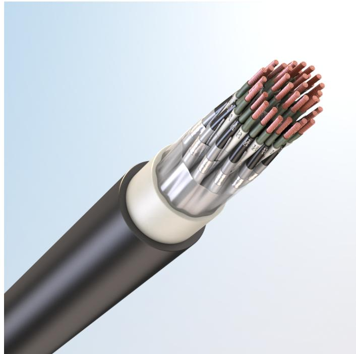
Кабель монтажный универсальный, огнестойкий, с медными токопроводящими жилами, с обмоткой по токопроводящим жилам слюдосодержащей лентой, с изоляцией из поливинилхлоридного пластика, с экраном по группам из медных луженых проволок, с наружной оболочкой из хладостойкого поливинилхлоридного пластика пониженной пожарной опасности, с низким дымо- и газовыделением
