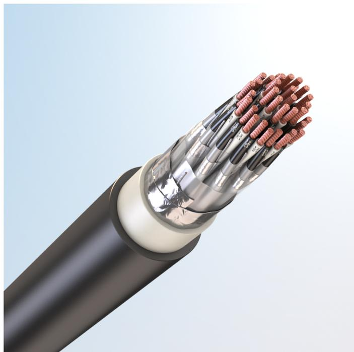
Кабель монтажный универсальный, с медными токопроводящими жилами, с изоляцией из поливинилхлоридного пластиката, с экраном по группам из медных луженых проволок, с общим экраном из медных проволок, с наружной оболочкой из поливинилхлоридного пластиката пониженной пожарной опасности
