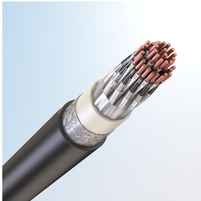
Кабель монтажный универсальный, с медными токопроводящими жилами, с изоляцией из полимерной композиции, не содержащей галогенов, с экраном по группам из медных проволок, бронированный стальными оцинкованными проволоками, с наружной оболочкой из полимерной композиции пониженной пожарной опасности, не содержащей галогенов
