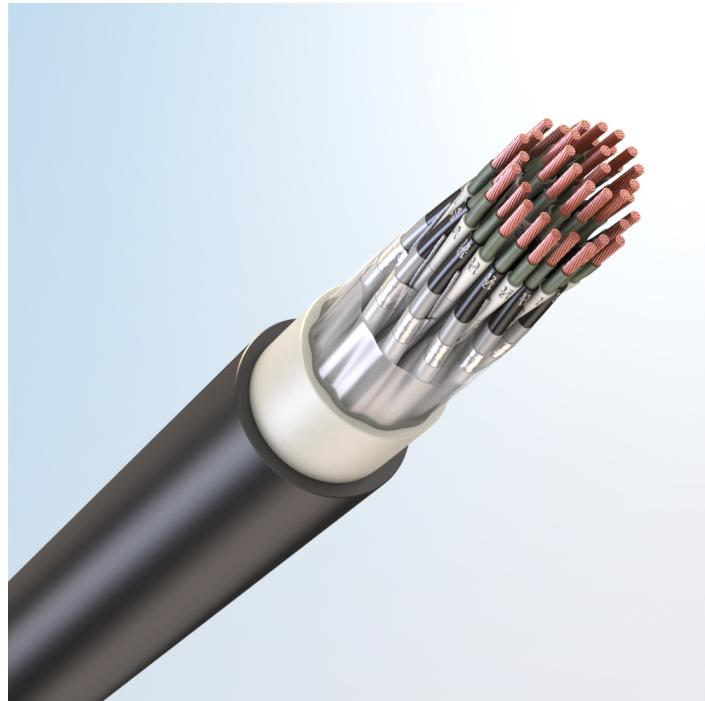
Кабель монтажный универсальный, огнестойкий, с медными токопроводящими жилами, с обмоткой по токопроводящим жилам слюдосодержащей лентой, с изоляцией из полимерной композиции, не содержащей галогенов, с экраном по группам из медных проволок, с наружной оболочкой из полимерной композиции пониженной пожарной опасности, не содержащей галогенов
