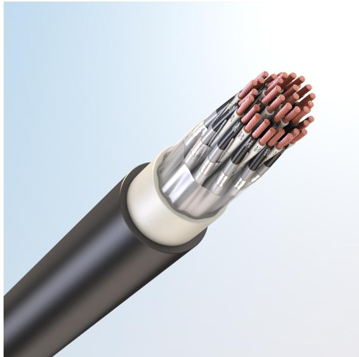
Кабель монтажный универсальный, с медными токопроводящими жилами, с изоляцией из полимерной композиции, не содержащей галогенов, с экраном по группам из медных проволок, с наружной оболочкой из полимерной композиции пониженной пожарной опасности, не содержащей галогенов
