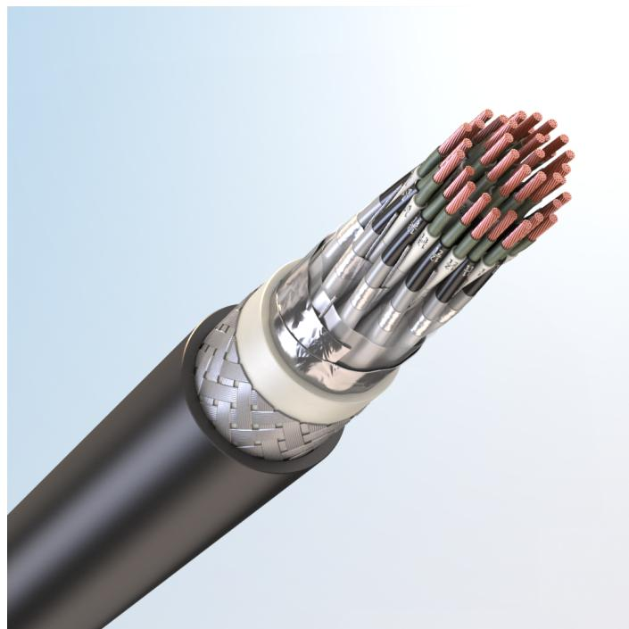
Кабель монтажный универсальный, огнестойкий, с медными токопроводящими жилами, с обмоткой по токопроводящим жилам слюдосодержащей лентой, с изоляцией из сшитого полиолефина, с экраном по группам из медных проволок, с общим экраном из медных проволок, бронированный стальными оцинкованными проволоками, с наружной оболочкой из полимерной композиции пониженной пожарной опасности, не содержащей галогенов
