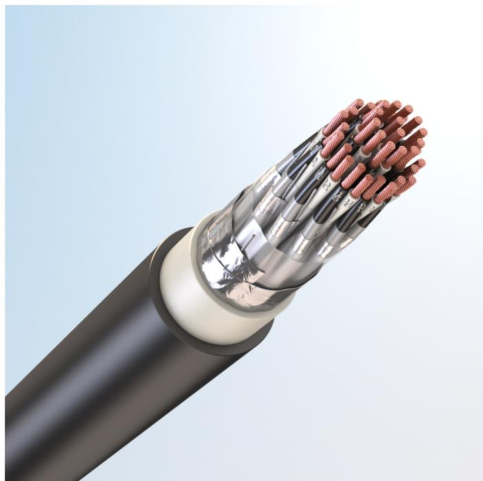
Кабель монтажный универсальный, с медными токопроводящими жилами, с изоляцией из термопластичного эластомера, с экраном по группам из медных проволок, с общим экраном из медных проволок, с наружной оболочкой из термопластичного эластомера пониженной пожарной опасности
