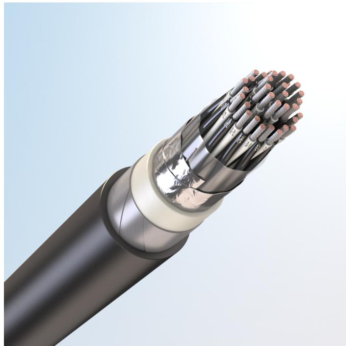
Кабель монтажный парной скрутки, с токопроводящими жилами из медных луженых проволок, с изоляцией из поливинилхлоридного пластика, с общим экраном из алюмополимерных лент, бронированный стальными оцинкованными лентами, с наружной оболочкой из поливинилхлоридного пластика пониженной пожарной опасности
