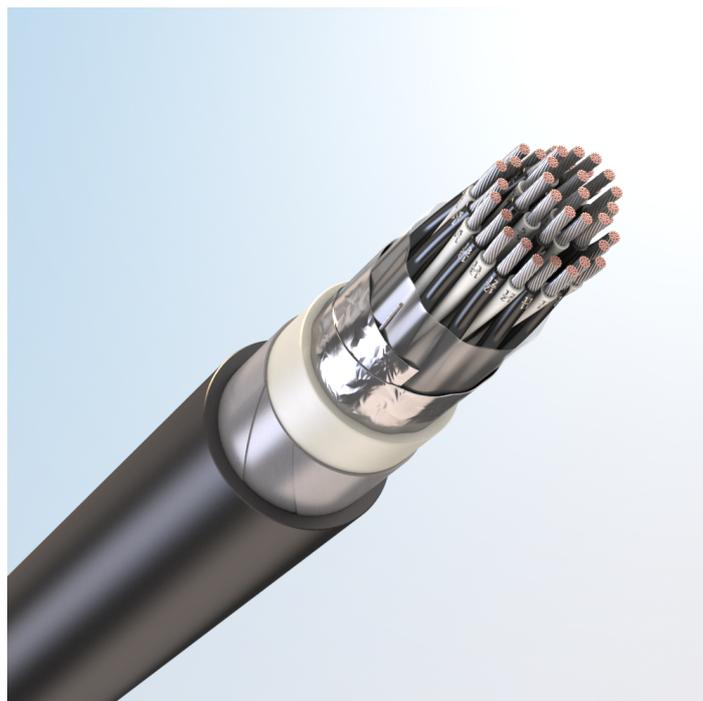
Кабель монтажный парной скрутки, с токопроводящими жилами из медных луженых проволок, с изоляцией из поливинилхлоридного пластиката, с общим экраном из алюмополимерных лент, бронированный стальными оцинкованными лентами, с наружной оболочкой из поливинилхлоридного пластиката пониженной пожарной опасности, с низким дымо- и газовыделением
