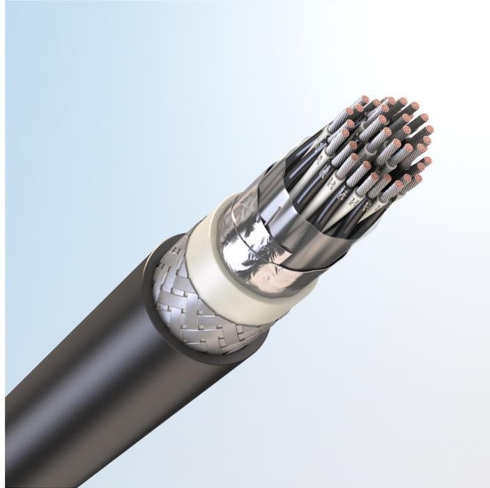
Кабель монтажный парной скрутки, с токопроводящими жилами из медных луженых проволок, с изоляцией из поливинилхлоридного пластиката, с общим экраном из алюмополимерных лент, бронированный стальными оцинкованными проволоками, с наружной оболочкой из поливинилхлоридного пластиката
