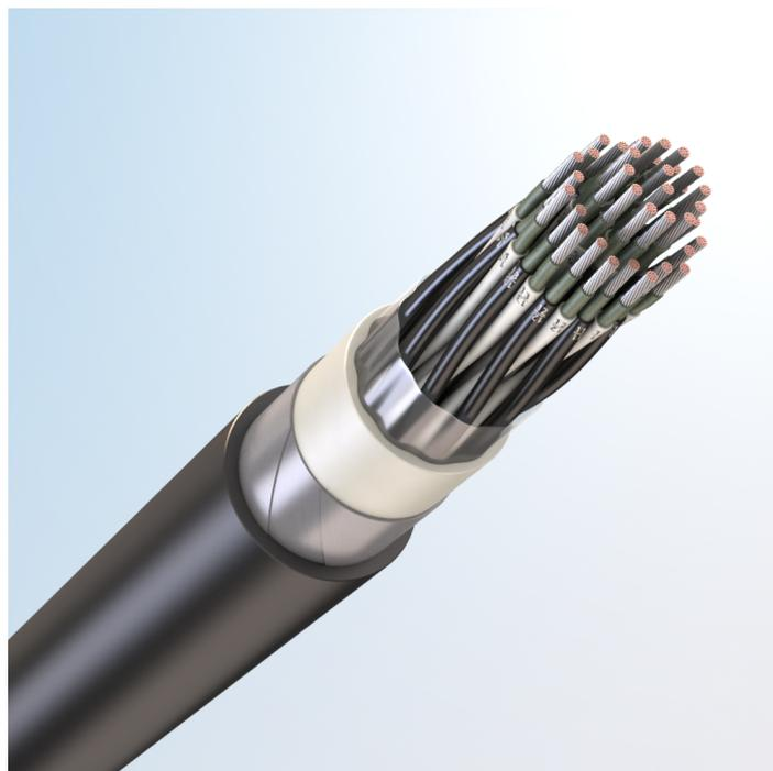
Кабель парной скрутки для высокоскоростной передачи данных, огнестойкий, с токопроводящими жилами из медных луженых проволок, с обмоткой по токопроводящим жилам слюдосодержащей лентой, с изоляцией из сшитого полиолефина, бронированный стальными оцинкованными лентами, с наружной оболочкой из поливинилхлоридного пластика пониженной пожарной опасности, с низким дымо- и газовыделением
