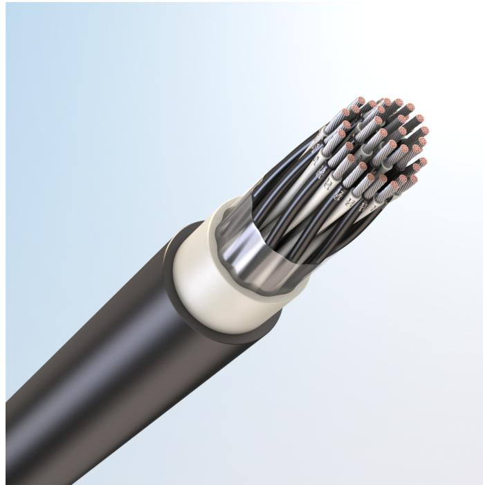
Кабель парной скрутки для высокоскоростной передачи данных, с токопроводящими жилами из медных луженых проволок, с изоляцией из сшитого полиолефина, с наружной оболочкой из поливинилхлоридного пластика
