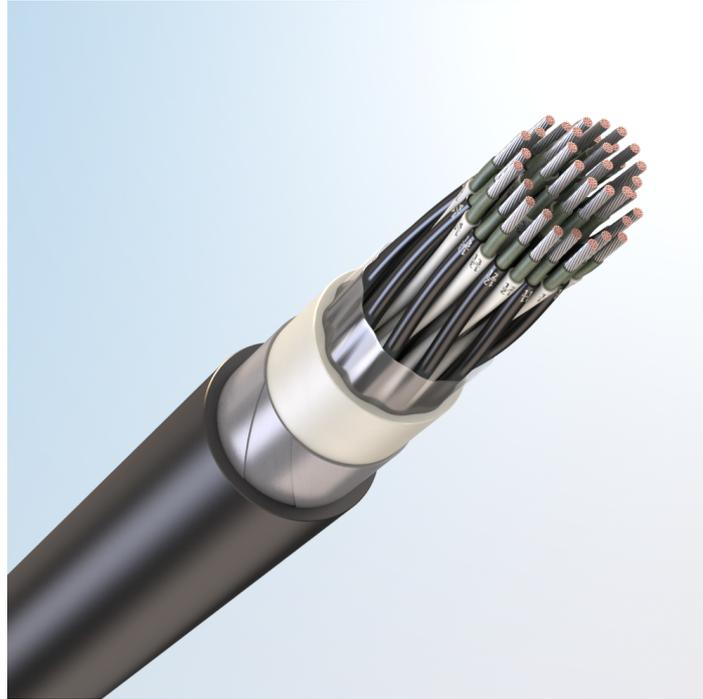
Кабель парной скрутки для высокоскоростной передачи данных, огнестойкий, с токопроводящими жилами из медных луженых проволок, с обмоткой по токопроводящим жилам слюдосодержащей лентой, с изоляцией из сшитого полиолефина, бронированный стальными оцинкованными лентами, с наружной оболочкой из поливинилхлоридного пластика пониженной пожарной опасности
