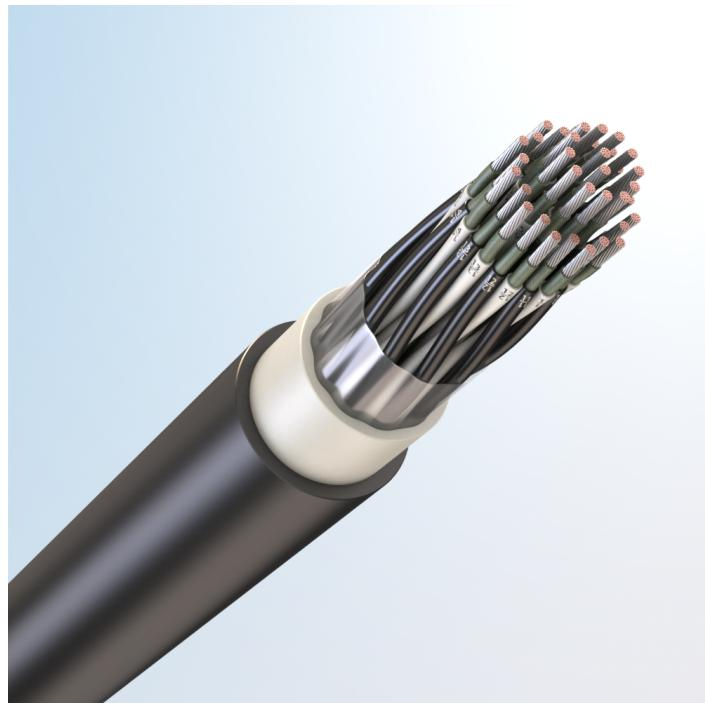
Кабель парной скрутки для высокоскоростной передачи данных, огнестойкий, с токопроводящими жилами из медных луженых проволок, с обмоткой по токопроводящим жилам слюдосодержащей лентой, с изоляцией из сшитого полиолефина, с наружной оболочкой из поливинилхлоридного пластика пониженной пожарной опасности, с низким дымо- и газовыделением
