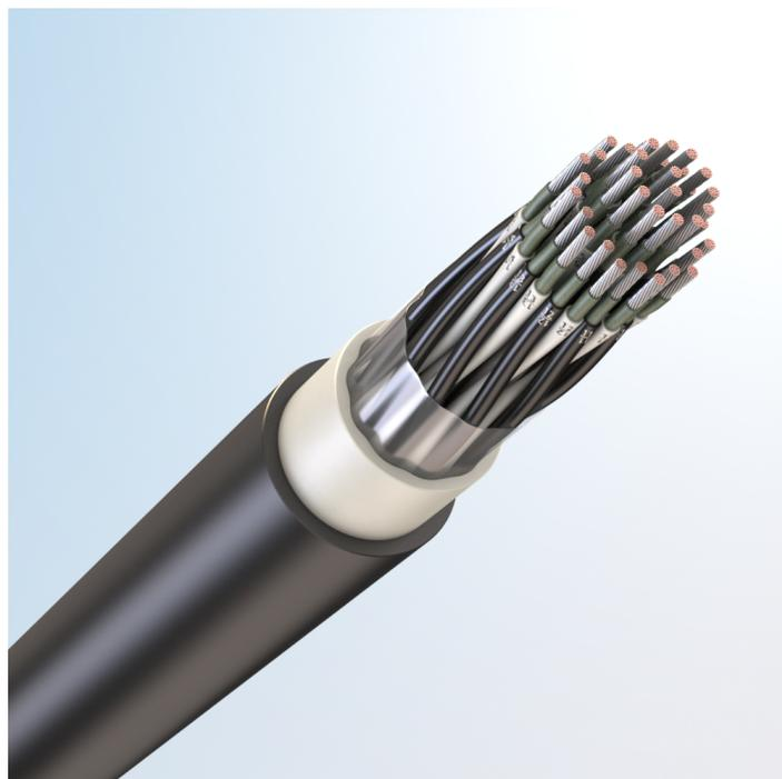
Кабель парной скрутки для высокоскоростной передачи данных, огнестойкий, с токопроводящими жилами из медных луженых проволок, с обмоткой по токопроводящим жилам слюдосодержащей лентой, с изоляцией из сшитого полиолефина, с наружной оболочкой из хладостойкого поливинилхлоридного пластиката пониженной пожарной опасности, с низким дымо- и газовыделением
