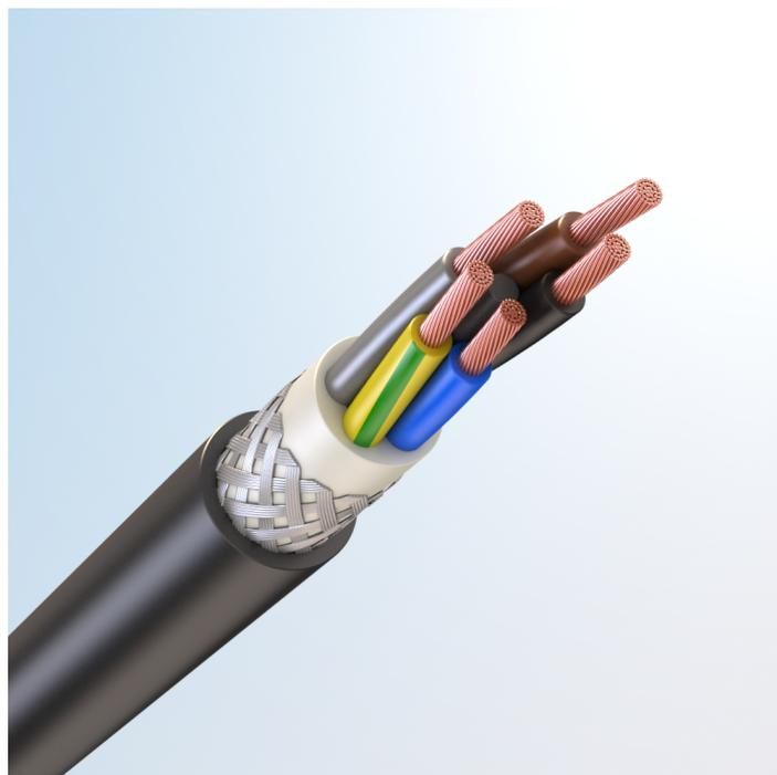
Кабель силовой гибкий, с медными токопроводящими жилами, с изоляцией из высокопрочной этиленпропиленовой резины НЕРР, бронированный стальными оцинкованными проволоками в виде оплетки, с наружной оболочкой из хладостойкого поливинилхлоридного пластика пониженной пожарной опасности
