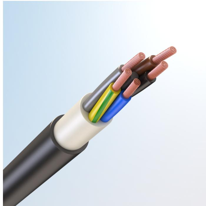
Кабель силовой гибкий, с медными токопроводящими жилами, с изоляцией из высокопрочной этиленпропиленовой резины НЕPR, с наружной оболочкой из высокопрочной этиленпропиленовой резины НЕPR пониженной пожарной опасности, не содержащей галогенов
